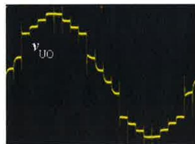
図3 出力電圧波形 (50V/div)
