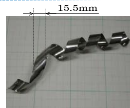
図2. 二重螺旋の誘導発熱体
