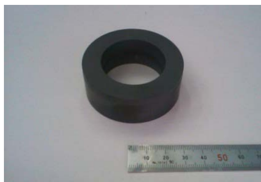
図1 工具として「せん断ダイス」にコーティングした外観
